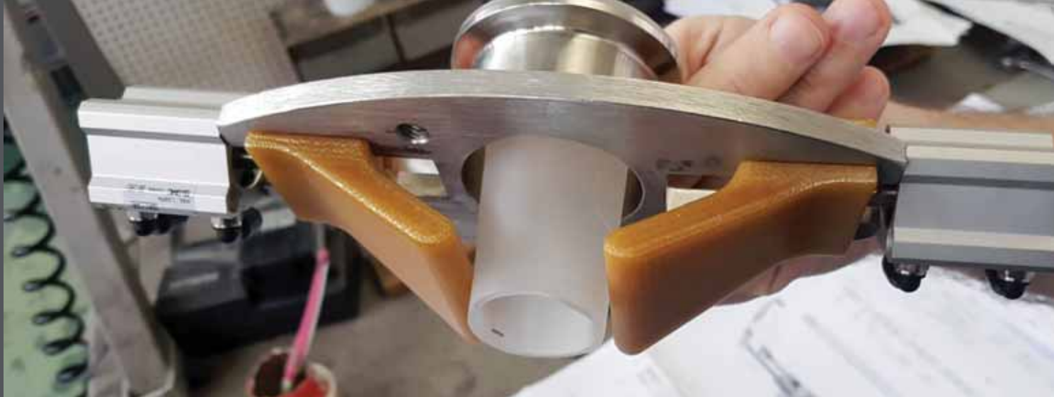
Pezzo finale di ricambio della macchina realizzato con la stampante 3D Fortus 450mc.
