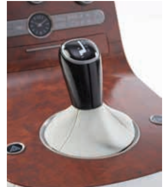
Le venature del legno, la parte inferiore del cambio in simil-pelle e il complesso intrigo di quadranti su questo prototipo di cruscotto sono il frutto di una singola stampa sulla stampante Stratasys J750.
