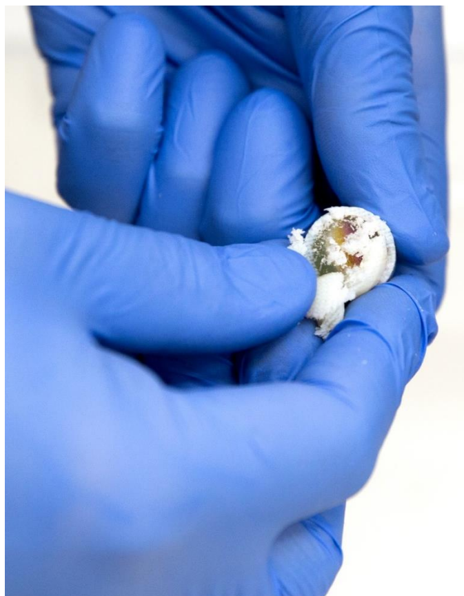
- 3 - Uno dei prototipi appena stampati viene facilmente liberato dal materiale di supporto
