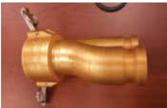
Questo nuovo ugello a Y realizzato nella resina ULTEM1010 è già in uso da otto mesi senza aver subito alcun danno.
