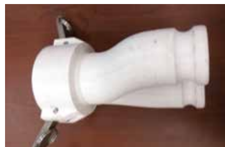
Il nuovo ugello a Y in materiale ABS non era sufficientemente resistente e si è crepato con l'uso.
