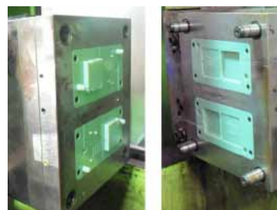
Figura 8: Inserti di stampo PolyJet sulla pressa ad iniezione. A sinistra il punzone e a destra la matrice.
