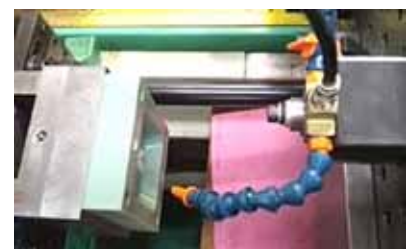
Figura 14: Dispositivo di raffreddamento montato sullo stampo. Mentre lo stampo si apre, sulla superficie viene applicata aria pressurizzata per un tempo predeterminato.
