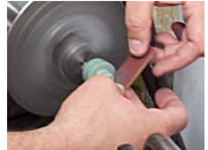
Figura 11: Finitura del componente dello stampo
