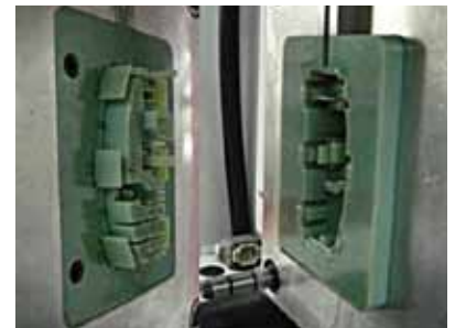
Figura 13: Gli inserti dello stampo vengono assemblati su una base in acciaio standard e tenuti in posizione con viti per macchine utensili.
