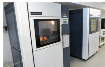
Il sistema di produzione 3D Fortus 400mc produce parti che includono Nolders, un profilo aerodinamico installato sotto il paraurti del veicolo.
