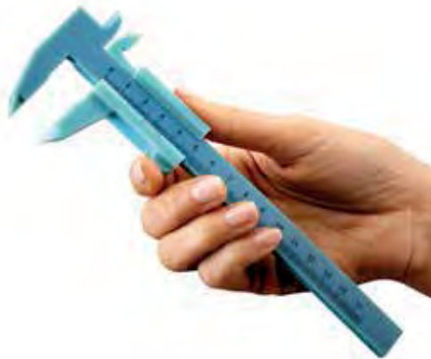
Figura 1. Questo calibro è stato stampato in 3D con materiali rigidi opachi.
