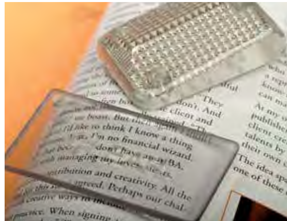
Figura 2. Lenti realizzate con VeroClear.
