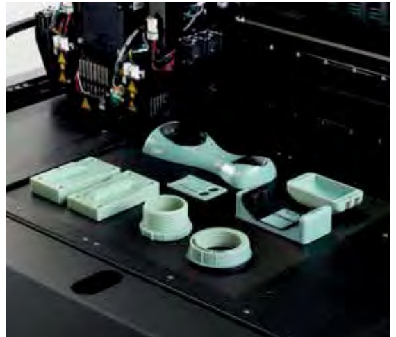
Figura 7. Con ABS digitale in verde sono stati prodotti tutti questi elementi funzionali (in senso orario, da sinistra): stampo a iniezione per bassi volumi, strumento a tasca, elemento di assemblaggio basato sulla geometria del prodotto, prototipo di custodia ed elemento di fissaggio corrispondente, due calibri di controllo di precisione filettati, ciascuno complementare a una parte di produzione per verificarne l'accuratezza. Superfici gommate e testo sono stati stampati in 3D direttamente sulle parti utilizzando il materiale TangoBlackPlus.
