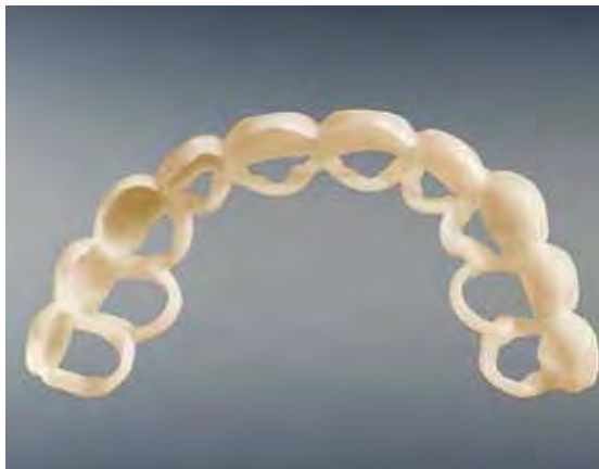
Figura 5. VeroGlaze utilizzato per faccette dentali di prova funzionali.
